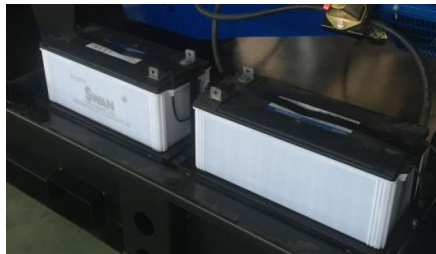
Batterie de démarrage 2 x 12 V / 60 Ah
